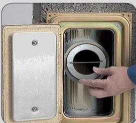
U slučaju priključenja konvencionalnih kotlova (rad u podprtisku - N 1 ) na dimnjački sistem Quadro PRO, na priključak za čišćenje potrebno je montirati vratanca za izjednačavanje pritiska sa prerezima
