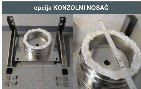
Odredite visinu na kojoj postavljate konzolni nosač. Konzola se pričvršćuje na zid pomoću šrafova i tiplova za beton. Nakon toga odredite potrebnu udaljenost dimnjaka od zida (u odnosu na zidni držač)
