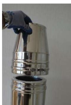
Montirajte konusni završetak na kraju dimnjaka. ICS ima obezbeđen odvod kondenzata kao i kapilarne brane na spojevima tako da na konus nije potrebno montirati poklopce protiv padavina.
