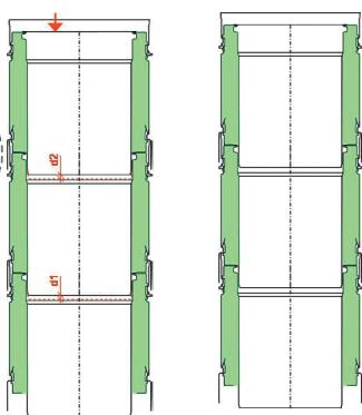
Kapilarna brana sprečava „curenje“ kondenza i gasa na spojevima.
