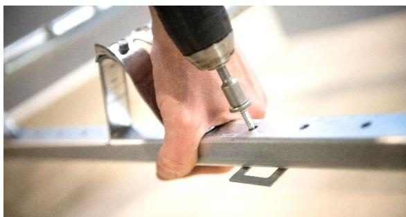
Bruk hjelpeverktøyet til å skru fast stagene til stigemodulen med skruer 6,3x25mm.
