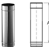
Elemento lineare di altezza utile 450 mm da utilizzare nei tratti verticali o in canali da fumo sub-orizzontali. Prevedere l'apposita fascetta stringitubo vd. Pos. 1E. Senza guarnizione adatto alle applicazioni in pressione negativa (N1). Per applicazioni in pressione positiva a 200 Pa (P1) prevedere l'aggiunta sulla testata maschio dell'apposita guarnizione di tenuta (vd. sez. COMPONENTI UNIVERSALI).
