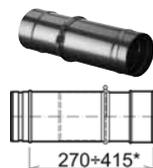
Consente una regolazione da 80 a 400 mm. In caso di camino verticale predisporre un elemento di supporto/scarico del peso subito al di sopra di ogni rettilineo regolabile. Per applicazioni in pressione positiva (P1) prevedere l'aggiunta di 2 guarnizioni (testata maschio + gola interna) ordinabili separatamente (Vd. sez. COMPONENTI UNIVERSALI).
