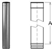
Elemento lineare di altezza utile 950 mm da utilizzare nei tratti verticali o in canali da fumo sub-orizzontali. Prevedere l'apposita fascetta stringitubo vd. Pos. 1E. Senza guarnizione adatto alle applicazioni in pressione negativa (N1). Per applicazioni in pressione positiva a 200 Pa (P1) prevedere l'aggiunta sulla testata maschio dell'apposita guarnizione di tenuta (vd. sez. COMPONENTI UNIVERSALI).
