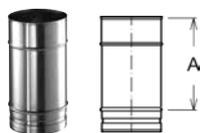
Elemento lineare di altezza utile 200 mm da utilizzare nei tratti verticali o in canali da fumo sub-orizzontali. Prevedere l'apposita fascetta stringitubo vd. Pos. 1E. Senza guarnizione adatto alle applicazioni in pressione negativa (N1). Per applicazioni in pressione positiva a 200 Pa (P1) prevedere l'aggiunta sulla testata maschio dell'apposita guarnizione di tenuta (vd. sez. COMPONENTI UNIVERSALI).
