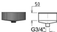
Elemento da utilizzare alla base del camino, dotato di manicotto filettato idoneo per il collegamento ad un condotto idraulico per lo scarico della condensa.
