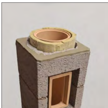
17. A normál építési sorrend következik egészen a füstcső-csatlakozóig. A köpenytéglára hordjunk fel habarcsot. (M5) Figyelem! A köpenytéglán belülre ne kerüljön habarcs!
