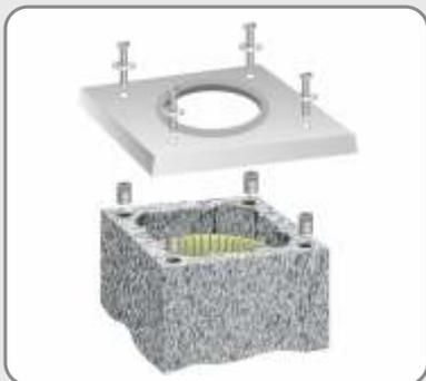
29 Na gornji rub plašta nanesite mort, namjestite završnu ploču i učvrstite vijcima ako se montira plašt od lakog betona. Ako se montira završna ploča od teškog betona, učvršćivanje vijcima nije potrebno.
