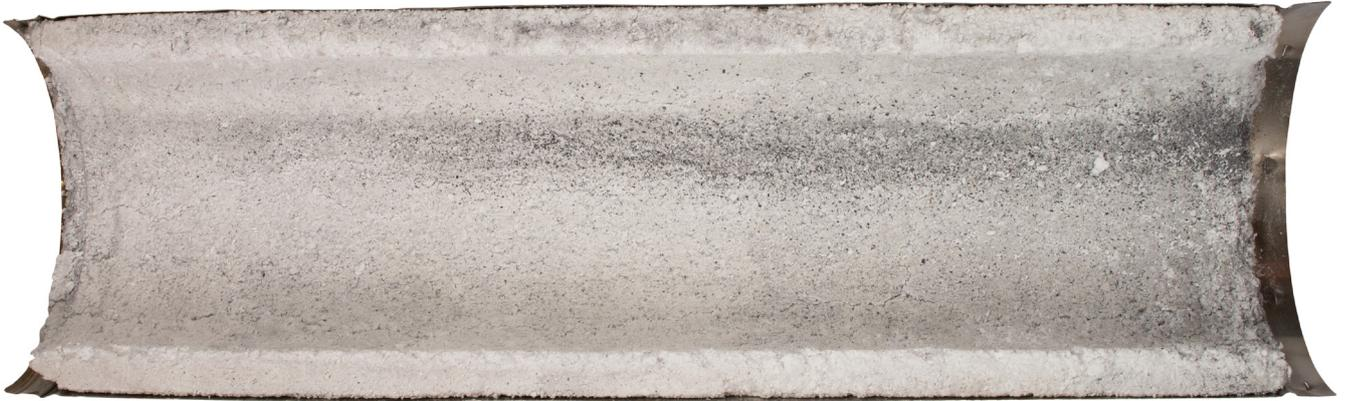
Illustration 4 : coupe transversale de l'élément de compteur Metaloterm AT avec isolation Amgiso après quatre tests de feu de cheminée
