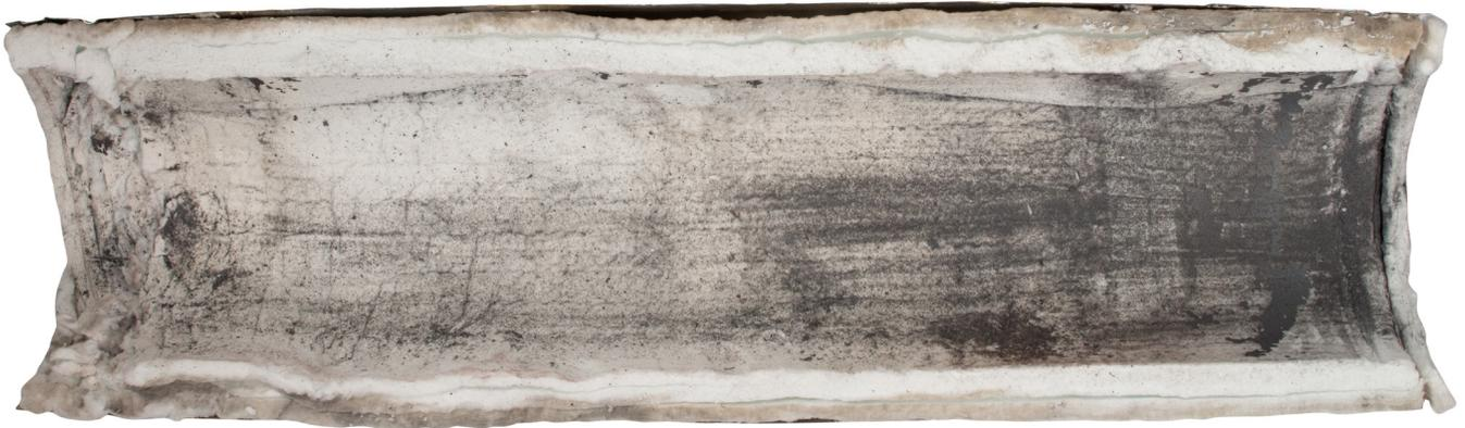
Illustration 5 : coupe transversale de l'élément de compteur Metaloterm AT avec isolation Schiedel Blanket après quatre tests de feu de cheminée
