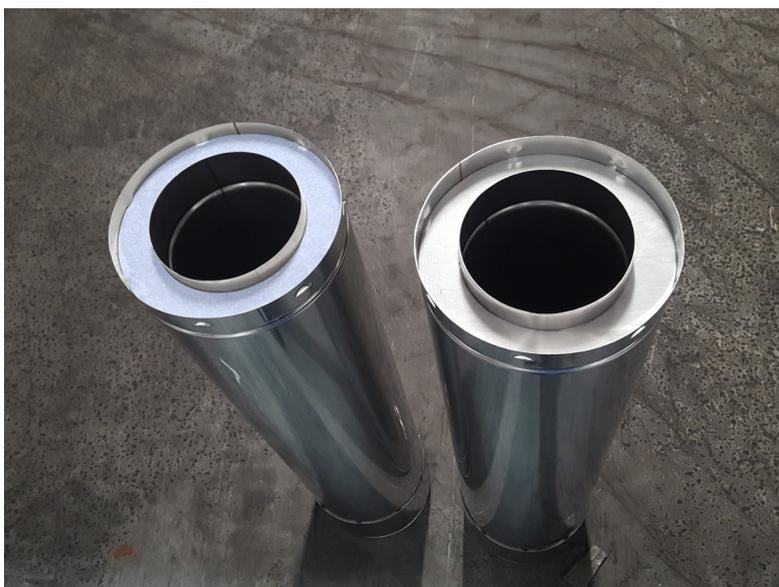
Illustration 2 : Les éléments de compteur AT d'une longueur de 965 mm du montage de test remplis d'Amgiso (à gauche) et de Schiedel Blanket (à droite)
