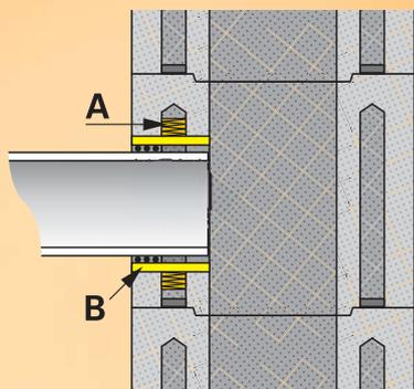
**7** Заполните воздушный канал вокруг отверстия прохода примерно на 3-5 см огнеупорным изоляционным материалом (A), чтобы избежать лишнего расхода смеси при выравнивании внутренней стороны отверстия. Затем выровняйте внутреннюю поверхность прохода клеевой смесью Isokern (B). Зазор между соединительной трубой и отверстием прохода заполните огнеупорным уплотнительным шнуром соответствующего размера, дополнительно можно на внешней поверхности прохода использовать огнеупорную уплотнительную массу.
