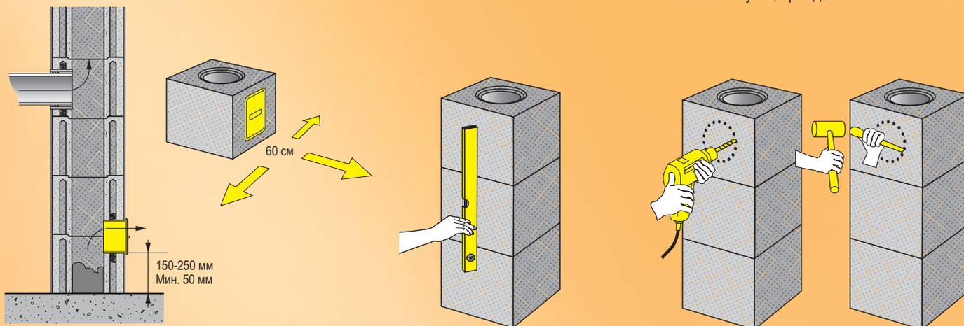
**4** Установите люк для сажи ниже очага. Самое удобное – сделать отверстие для люка в соответствующем блоке в ходе его монтажа. Отметьте на блоке контур отверстия для люка. Просверлите электродрелью отверстия вдоль контурной линии. Не пользуйтесь ударной дрелью. Для вырезания отверстия можно использовать и резак с отрезным кругом, предназначенным для легкого бетона. Обработайте молотком и зубилом. На полу перед люком для сажи должно остаться не менее 60 см свободного места.
