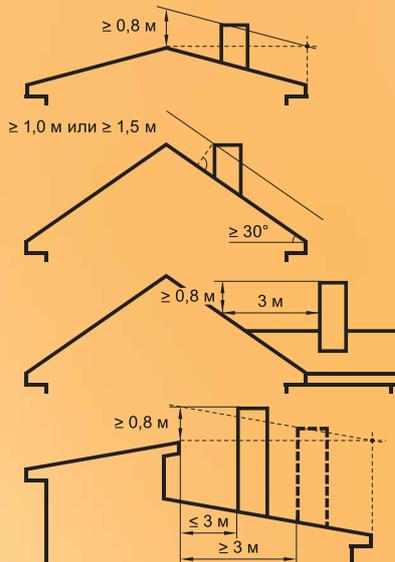
Если кровля не относится к классу огнеупорности Vgroof, соответствующая высота должна быть не менее 1,2 м и для дымохода предусматривается искроуловитель, следует также дополнительно подтвердить пожарную безопасность дымохода. Рекомендуемая вертикальная высота дымохода, выступающая за поверхность кровли, составляет max 1,5 м. Для обеспечения лучшей стабильности рекомендуем зафиксировать дымоход и в проходе его через кровельную конструкцию (см. пункт 9).
