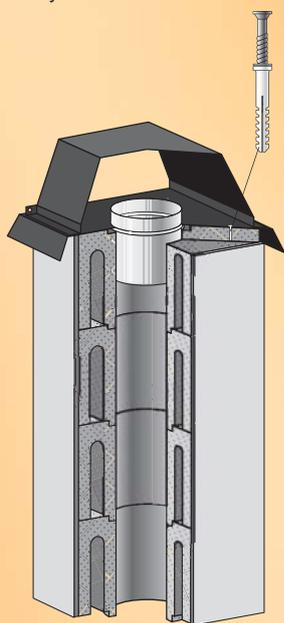
**10** Выступающую над крышей часть дымохода облицуйте кирпичом, штукатуркой или жестяной обшивкой. Проход через нижнее покрытие крыши и кровлю уплотните в соответствии с рекомендациями и инструкциями их изготовителя. Соединение дымохода с кровлей должно быть погодоустойчивым и водонепроницаемым и должно соответствовать материалу наружной обшивки дымохода. При оштукатуренной верхней части трубы дымохода облицуйте наружную поверхность дымохода слоем погодоустойчивой штукатурки толщиной 10 мм.
