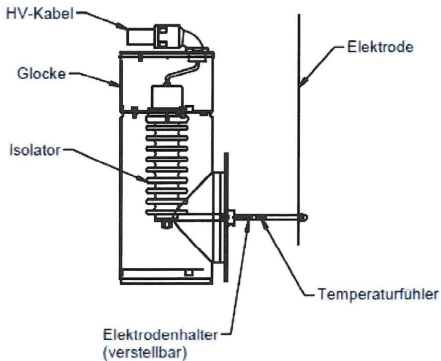
Einrichtungen zur Staubreduktion (Staubabscheider) Typ "Airjekt 1", "Airjekt 1 Basic",
