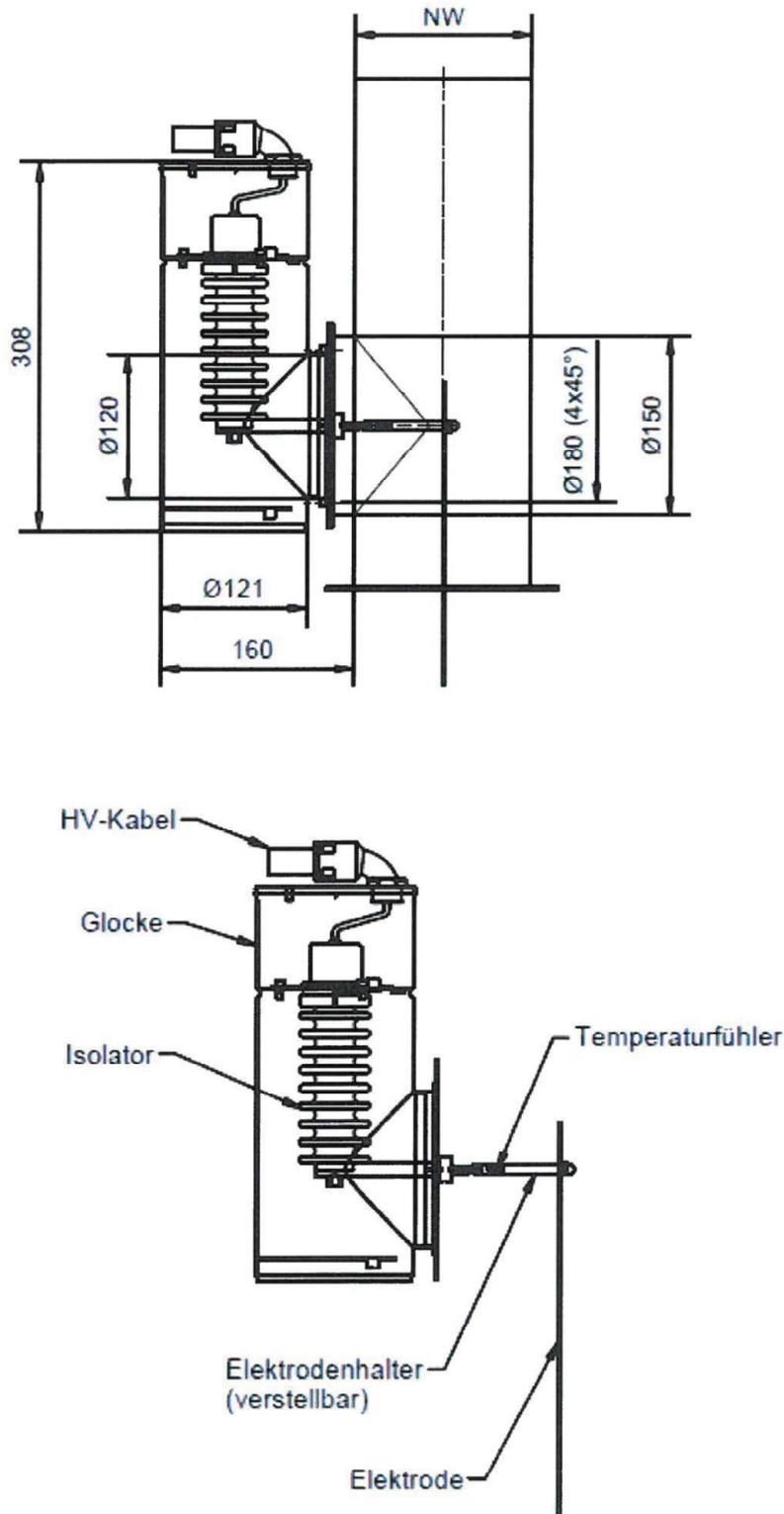
Einrichtungen zur Staubreduktion (Staubabscheider) Typ "Airjekt 1", "Airjekt 1 Basic",
