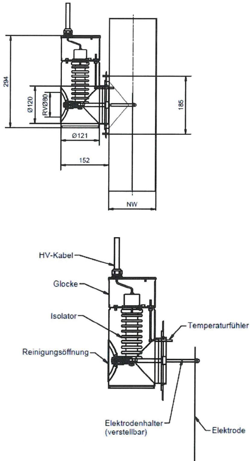
Einrichtungen zur Staubreduktion (Staubabscheider) Typ "Airjekt 1", "Airjekt 1 Basic",
