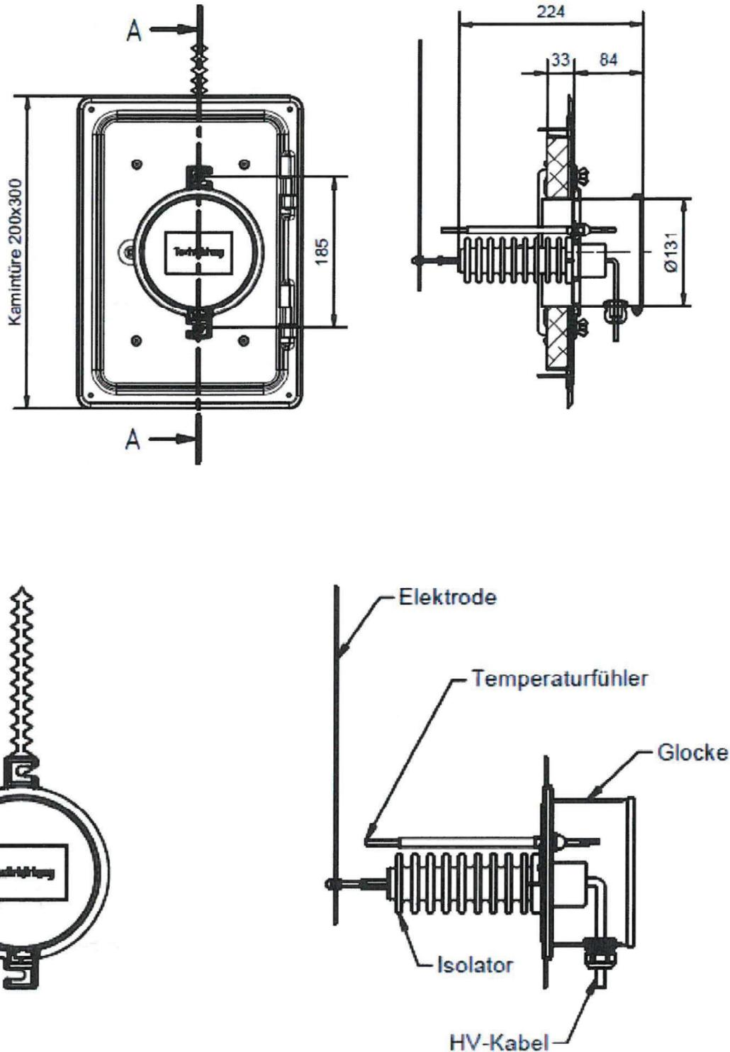
Einrichtungen zur Staubreduktion (Staubabscheider) Typ "Airjekt 1", "Airjekt 1 Basic", "Airjekt 1 Outdoor DW", "Airjekt 1 Outdoor Top" und "Airjekt 1 Ceramic" für Abgasanlagen
