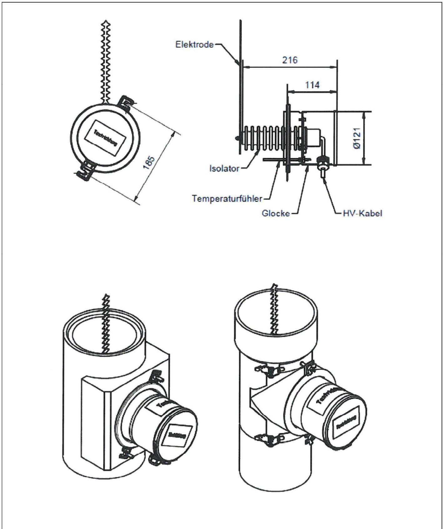
Einrichtungen zur Staubreduktion (Staubabscheider) Typ "Airjekt 1", "Airjekt 1 Basic",
