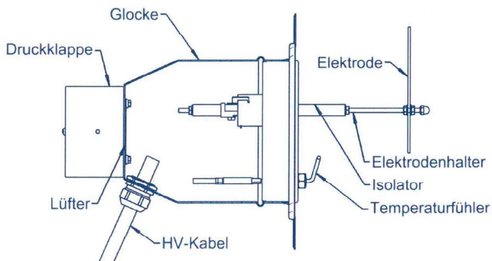
Einrichtungen zur Staubreduktion (Staubabscheider) Typ "Airjekt 1", "Airjekt 1 Basic",
