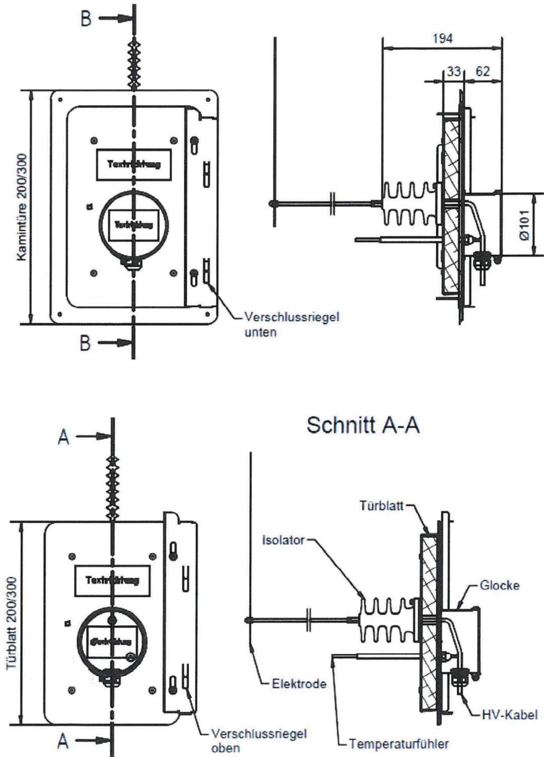
Einrichtungen zur Staubreduktion (Staubabscheider) Typ "Airjekt 1", "Airjekt 1 Basic",
