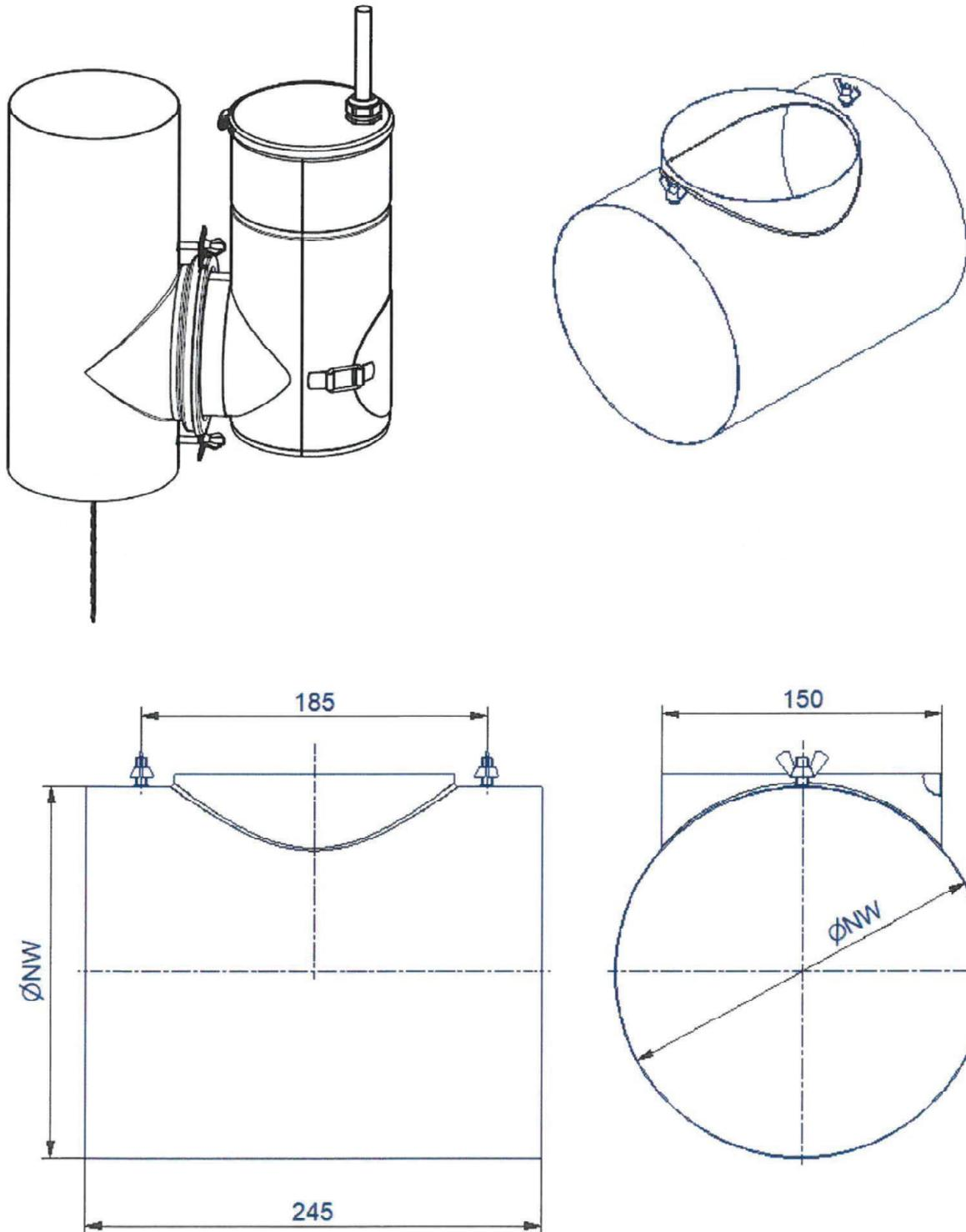
Einrichtungen zur Staubreduktion (Staubabscheider) Typ "Airjekt 1", "Airjekt 1 Basic",
