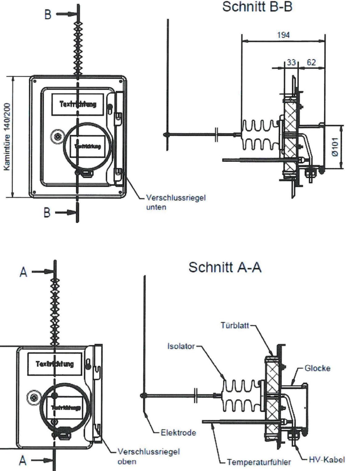
Einrichtungen zur Staubreduktion (Staubabscheider) Typ "Airjekt 1", "Airjekt 1 Basic",
