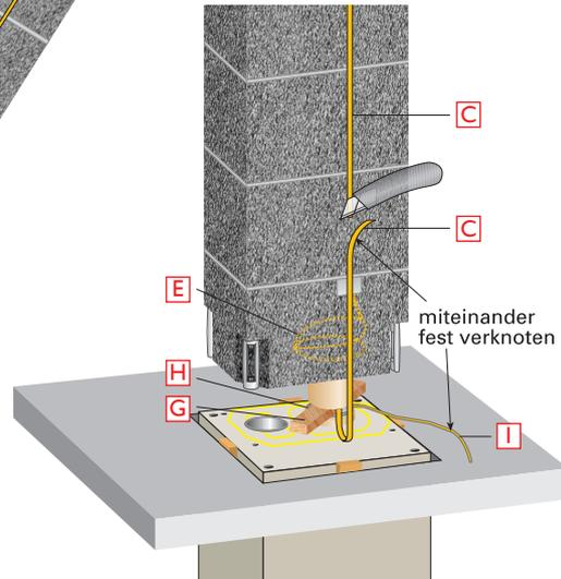
Innenrohr vom ABSOLUT PARAT- Element auf Absetzholz (G) aufsetzen. Erst jetzt gelbes Transportsicherungsband (C) durchtrennen. Innen verlaufendes Transportsicherungsband (C) am Seil (I) der Versetzhilfe (H) fest verknöten (Doppelknoten).
