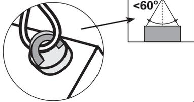
Unterlage zum Schutz der Elementkanten vorsehen. Element aufrichten. Aufrichthilfen (D) erst nach dem Anheben entfernen!
