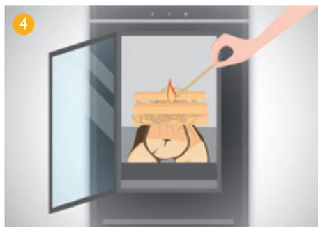
4. Entfachen Sie das Feuer von oben mit z.B. langen Zündhölzern. Schließen Sie danach die Feuerraumtür. Bereits nach kurzer Zeit entwickeln sich sichtbare Flammen im Feuerraum.
