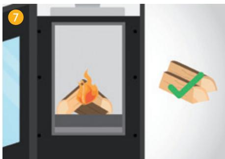
7. Um Rauchaustritt zu vermeiden, öffnen Sie die Tür langsam. Legen Sie maximal zwei kleine Holzscheite, mit der Spaltkante nach unten, nach. Keinesfalls sollten Sie den Brennstoff in den Feuerraum hineinwerfen. Dies könnte die Auskleidung des Feuerraumes beschädigen und das Austreten von Glutstücken verursachen.
