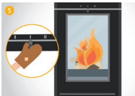
5. Wenn das gesamte Holz brennt, verringern Sie die Luftzufuhr, indem Sie den Regler auf „Heizbetrieb“ stellen. Verschieben Sie dazu den Luftregler oberhalb des Feuerraumes von Position II auf Position I.
