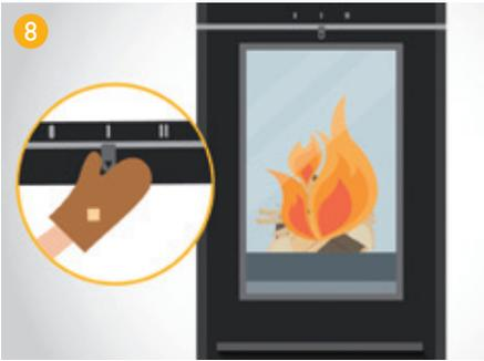
8. Sobald die Scheite überzündet haben, reduzieren Sie die Verbrennungsluftzufuhr wieder, indem Sie den Regler auf „Heizbetrieb“ (Position I) stellen.
