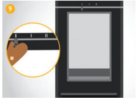
9. Wenn Sie das Feuer beenden wollen, lassen Sie die Restglut erlöschen. Danach schließen Sie den Luftregler. Verschieben Sie dazu den Luftregler oberhalb des Feuerraumes auf Position 0.
