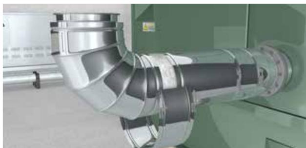
Das universelle Abgassystem Schiedel HP 5000 ist sowohl **einwandig als auch doppelwandig** lieferbar. Gemäß der europäischen Normung wurde das System für Temperaturen im **Dauerbetrieb bis 600 °C** und einem **Überdruck bis 5.000 Pa** geprüft und zertifiziert. Somit ist es speziell für hohe Abgastemperaturen und hohe Druckverhältnisse prädestiniert.
