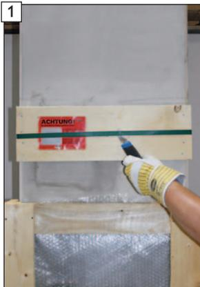
1 Äußere Transportschutzverpackung entfernen.
