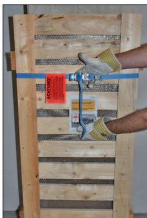
2. Um Beschädigungen zu verhindern Transportschutzverpackung sicher festhalten, **oberen** Spanngurt öffnen und die Schutzverpackung vorsichtig abnehmen.
