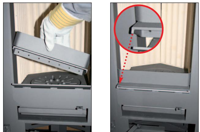
1. Den Luftspoiler von hinten im Bereich der Innenkeramik schräg einsetzen und mit den Haltenasen am Leitblech aufsetzen.
