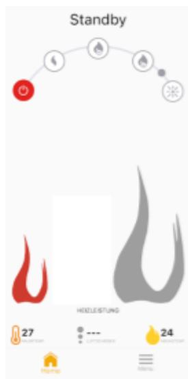
Beim „TÜV cert“ Abbrandmodus stehen nur 2 Heizleistungsstufen (Teillast und Vollast) zur Verfügung. Je nach Abbrandstärke müssen Sie die korrekte Stufe auswählen. Die kleine Flamme ist für Teillast, die große für Vollast.
