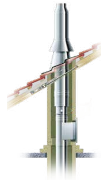
Beispiel: doppelwandiges Edelstahlelement als Verkleidung über Dach.
