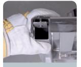
Schutzkappen zur weiteren Montage abziehen und Gewindeplatten in Grundplatte einschieben. Vorerst nur leicht verschrauben!
