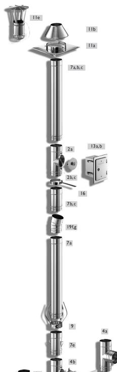
Am Ablassrohr 250 (7e) wird die Rohrsäule mit einem Seil von oben abgelassen. Die Rohrelemente (7a, 7b, 7c) mit einer Bauhöhe von 950, 450 und 200 mm werden ineinandergesteckt und mit von oben abgelassen.
