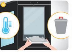
10. Ist die Aschenlade voll, muss Sie vollständig abkühlen, bevor sie in einen Metalleimer mit Deckel
