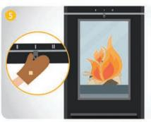
5. Wenn das gesamte Holz brennt, verringern Sie die Luftzufuhr, indem Sie den Regler auf "Heizbetrieb" stellen. Verschieben Sie dazu den Luftregler oberhalb des Feuerraumes von Position II auf Position I.
