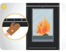
8. Sobald die Scheite überzündet haben, reduzieren Sie die Verbrennungsluftzufuhr wieder, indem Sie den Regler auf "Heizbetrieb" (Position I) stellen.
