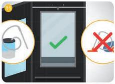
11. Die Reinigung des Brennraums funktioniert am besten mit einem speziellen Aschesauger. Bitte verwenden Sie dafür auf keinen Fall Ihren Hausstaubsauger.
