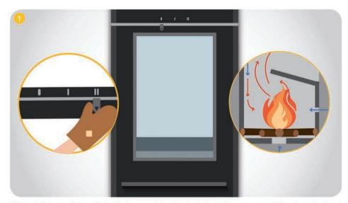
1. Zum Anheizen schieben Sie den Verbrennungsluftregler oberhalb der Brennraumtür auf die "Anzündstellung". Verschieben Sie dazu den Luftregler oberhalb des Feuerraumes von Position 0 auf Position II. So wird die Luftzufuhr maximal geöffnet.
