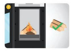
7. Um Rauchaustritt zu vermeiden, öffnen Sie die Türlangsam. Legen Sie maximal zwei kleine Holzscheite, mit der Spaltkante nach unten, nach. Keinesfalls sollten Sie den Brennstoff in den Feuerraum hineinwerfen. Dieses könnte die Auskleidung des Feuerraums beschädigen und das Austreten von Glutstücken verursachen.
