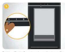
Wenn Sie das Feuer beenden wollen, lassen Sie die Restglut erlöschen. Danach schließen Sie den Luftregler: Verschieben Sie dazu den Luftregler oberhalb des Feuerraumes auf Position 0.
