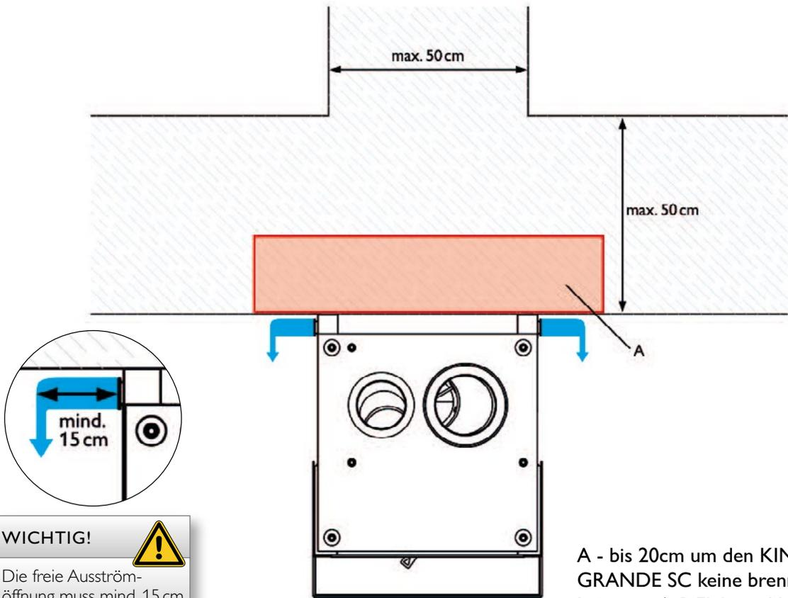
A - bis 20cm um den KINGFIRE GRANDE SC keine brennbaren Leitungen (z.B. Elektro-, Wasser- od. sonst. Mediemleitungen) verbauen.
