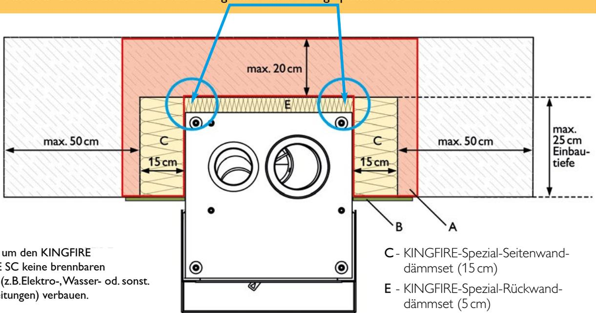
A - bis 20cm um den KINGFIRE GRANDE SC keine brennbaren Leitungen (z.B. Elektro-, Wasser- od. sonst. Mediemleitungen) verbauen.
