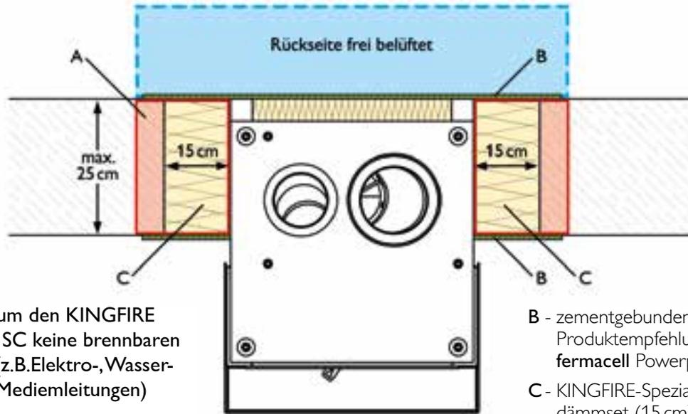
A - bis 20cm um den KINGFIRE GRANDE SC keine brennbaren Leitungen (z.B. Elektro-, Wasser- od. sonst. Mediemleitungen) verbauen.
