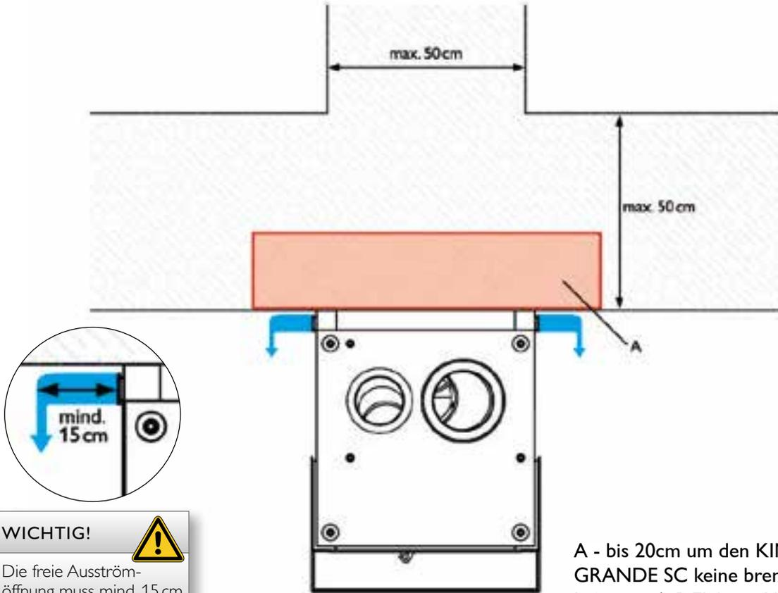
A - bis 20cm um den KINGFIRE GRANDE SC keine brennbaren Leitungen (z.B. Elektro-, Wasser- od. sonst. Mediemleitungen) verbauen.
