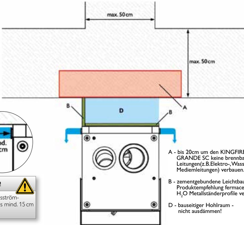
A - bis 20cm um den KINGFIRE GRANDE SC keine brennbaren Leitungen (z.B. Elektro-, Wasser- od. sonst. Medientleitungen) verbauen.
