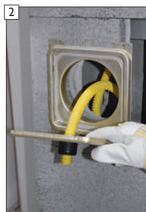
2 Sejměte dvířka BlowerDoor a vytáhněte adaptér pro připojení HT potrubí DN40 se sifonovou hadicí.
