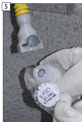
5 Odstraňte těsnění na spojce adaptéru prázdného sáčku na sběr kondenzátu.
