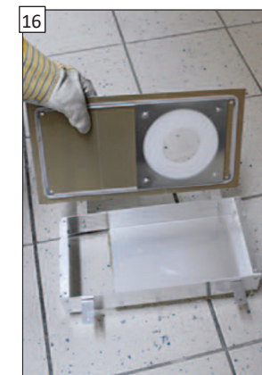
Odstraňte kryt adaptéru přiváděného vzduchu LAS. POZOR! Nepoškodte těsnicí pásku!
