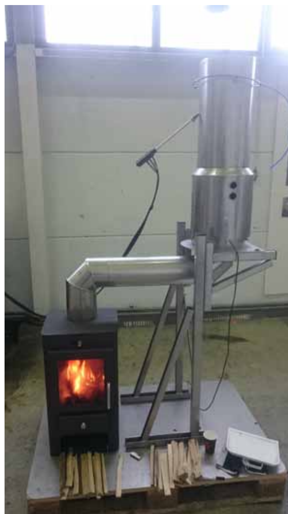
Opstelling voor rookanalyse
